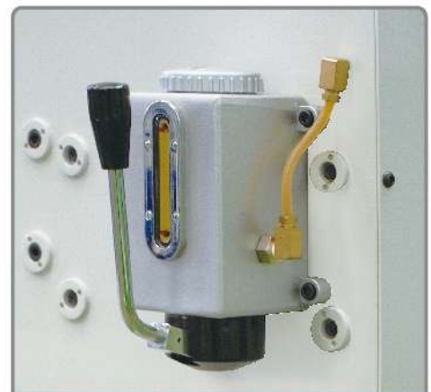
Manual Lubrication System 手動潤滑系統
